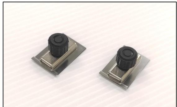
試料固定用の磁石が2個付属しています。
