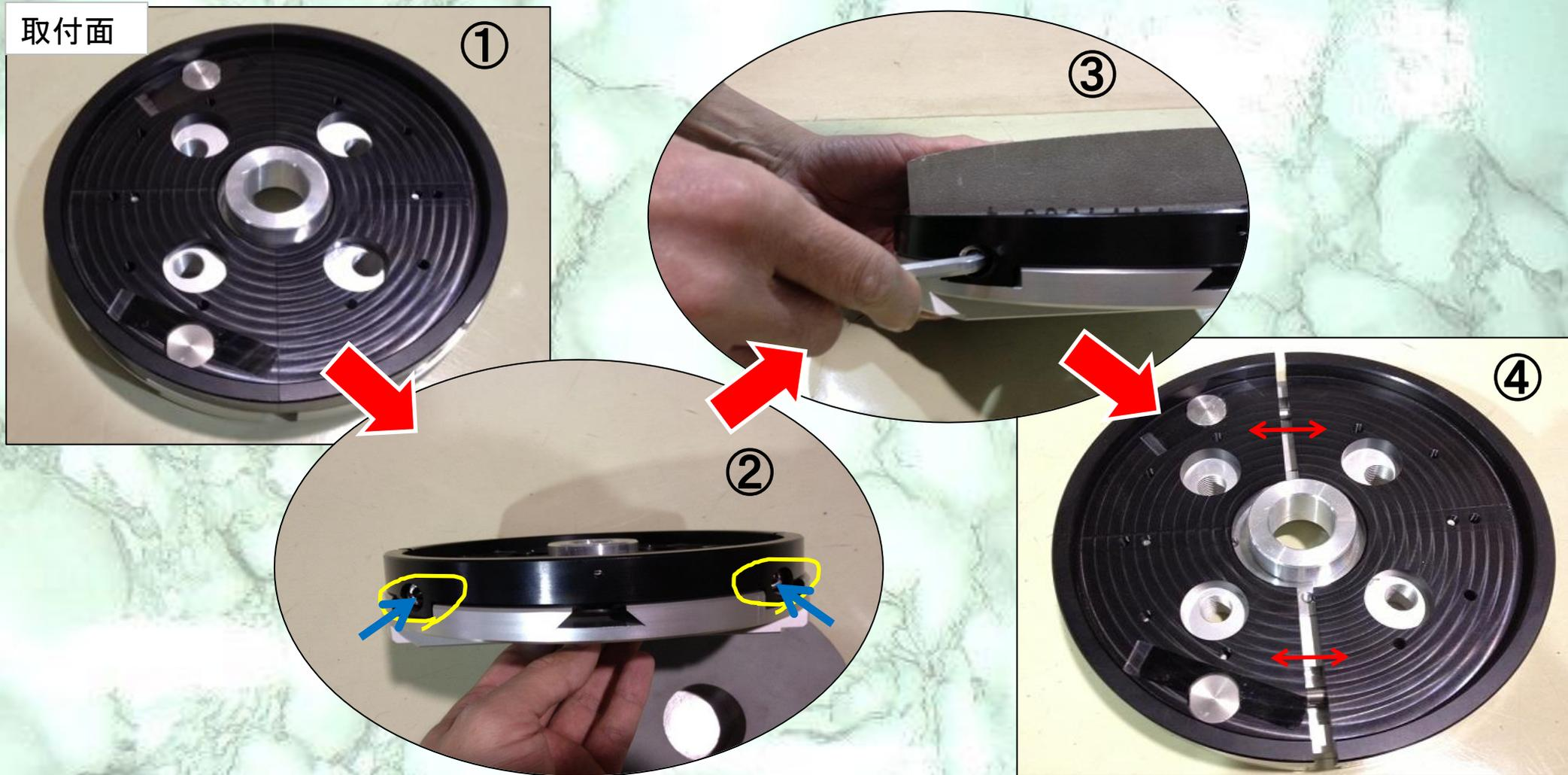
側面の2本のネジを緩め、左右のプレートを動かし砥石をセットする。
